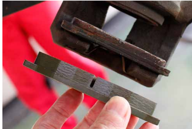
消耗しきって焼き付いてしまったパッド(上)と新品のパッド(下)
